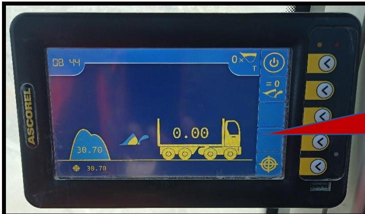
Placer le godet en position fermée et appuyer sur le bouton de remise à zéro de la tare
