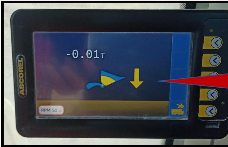
Baisser le godet jusqu'à ce que la balance revienne en mode CHARGE
