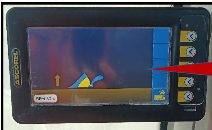
Lever l'équipement lentement et sans à-coup jusqu'à ce que la balance indique l'arrêt du levage en maintenant un régime moteur de 1500 tours/minute.
